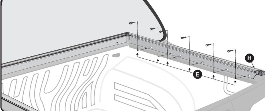
ÿ Remover parafuso original (-E) da lateral da pick up, posicionar perfil lateral (-H-) e prende-lo utilizando o parafuso original.
