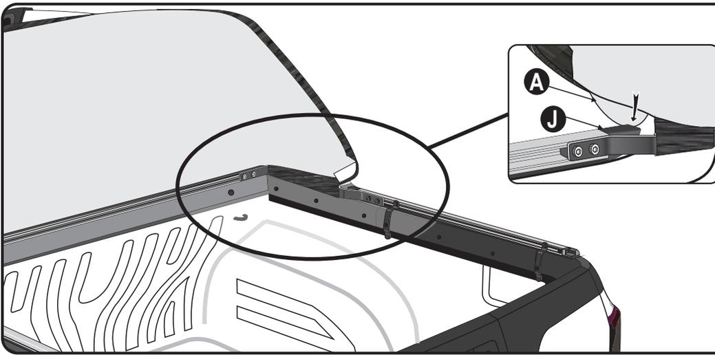
ÿ Encaixar a lâmina plástica da lona (-A) por baixo da ponteira abaulada (-J) para um perfeito acabamento sem rugas.
