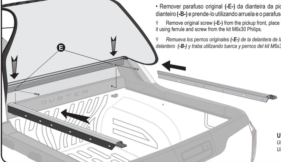
• Remover parafuso original (-E) da dianteira da pick up, posicionar perfil dianteiro (-B-) e prende-lo utilizando arruela e o parafuso do kit M6x30 Philips .
