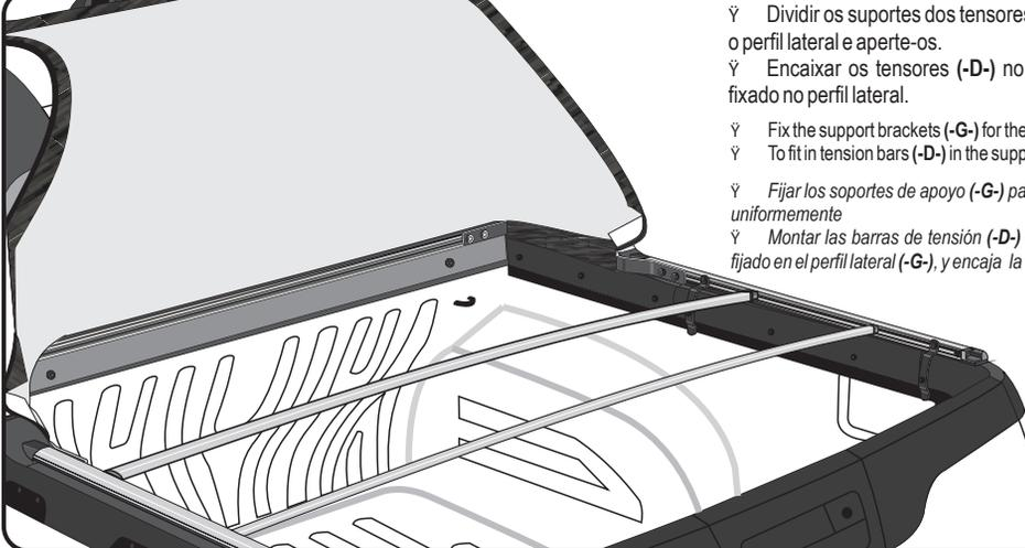
ÿ Dividir os suportes dos tensores (-G-) proporcionalmente sobre o perfil lateral e aperte-os.
